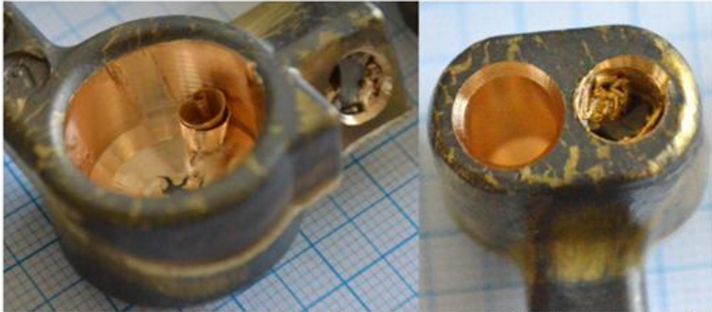
Abb. 4 Foto der unvollständig ausgeführten Bohrungen an einem M57-Muster. In den kleinen Bohrungen stecken jeweils Reste eines abgebrochenen Bohrers.
